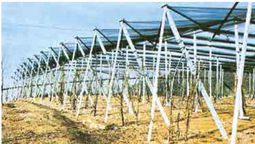
Fabbricati secondo criteri più moderni, presentano caratteristiche di massima elasticità, resistenza e minimo peso. Per una buona riuscita dei Vostri impianti, interrare le testate da 80 a 100 cm e i pali intermedi da 60 a 80 cm. Per zone sollecitate da venti, alternate ogni tanto dei pali di testata ai pali intermedi.
