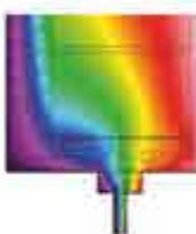
Andamento della temperatura di un muro esterno in laterizio isolato a cappotto in corrispondenza di un vano finestra realizzato con architrave in laterizio.
