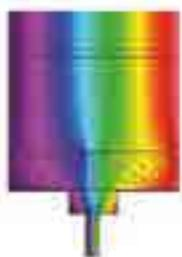
Andamento della temperatura di un muro esterno in laterizio non isolato in corrispondenza del vano finestra.
