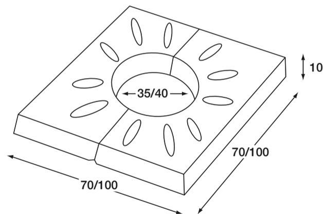
Griglia per alberi di forma quadrata, divisa in due pezzi, con feritoie interne disposte a raggiera. Costruito con materiale di 1ª scelta selezionato accuratamente con l'aggiunta di specifici additivi per consentire ai prodotti di resistere all'inquinamento urbano e di resistere in condizioni climatiche marine particolarmente umide.
