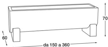
Fioriera a pianta rettangolare con fondo stondato realizzata in conglomerato cementizio armato per migliorare l'aderenza e fibrorinforzata ad alta resistenza meccanica, progettato con un sistema d'appoggio a terra su supporti anch'essi in cemento.
