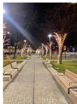
Elemento Panchina SEDUTA con SCHIENALE lineare e stondata fissata su Elemento arredo LINEA MONOLITICA TRI PLOK composta da DOGHE IN LEGNO MASSELLO CON TRATTAMENTO IMPREGNANTE ALL'ACQUA CON BRACCIOLO fissati su 3 telai in acciaio Zincato e verniciato.
